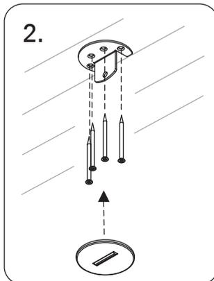
Die Strukturen der Saunadecke muss stark genug für das Gewicht des Saunaofens sein. Wählen Sie Befestigungsschrauben nach dem Material der Strukturen aus. Die mitgelieferten Schrauben eignen sich für Holz.
